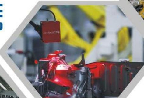
涂装厂厂房长264m, 宽61m, 占地面积17114m<sup>2</sup>, 建筑面积35736m<sup>2</sup>, 厂房采用主体两层, 局部三层结构, 其中一层为工作业区、二层为高洁净度喷涂区, 三层为厂房空调系统区, 车间整体采用全密闭全送风的空气循环系统, 以保证整个车间内部的空气洁净度。车间采用车型自动识别系统、整线自动化运行输送系统、配备56台自动化机器人(德国杜尔品牌), 实现自动粗密封以及内外板喷涂, 满足柔性化生产需求; 采用绿色环保的薄膜前处理、国际领先的水性免中涂紧凑工艺及节能环保的干式漆雾捕集系统技术; 通过白车身清洁度控制、自动化过程参数监控、色差管理、漆膜性能检测、油漆车身气密性检测等管控环节, 保证交付一流的油漆车身。
